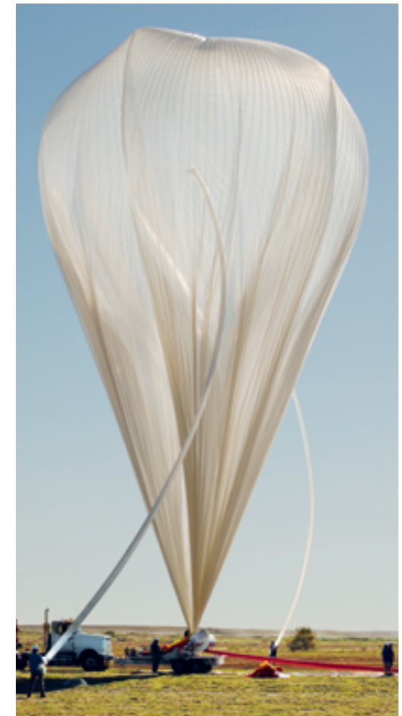
850 000 Kubikmeter Helium tragen den Ballon mit dem Sunrise-Teleskop in 35 bis 40 Kilometer Höhe. Von dort soll das Instrument hochaufgelöste Bilder der Sonnenoberfläche liefern.
